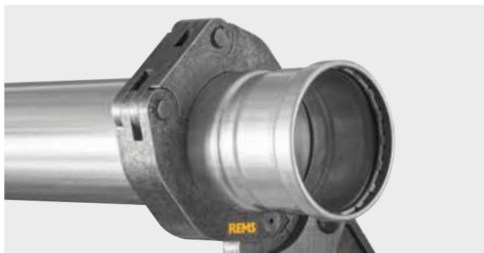
Пресс-клещи REMS (PR-3B) с 3 «плавающими» пресс-контурами для обжима фитингов больших размеров, к которым предъявляются особые требования. Оптимальный обжим благодаря радиально направленному движению «плавающих» пресс-контуров, с промежуточной фиксацией.
